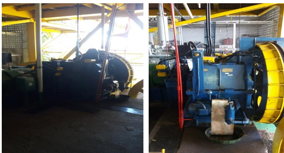
Sistema Motriz existente (a) Motor Elétrico/Principal e (b) Motor a Diesel/Reserva.
